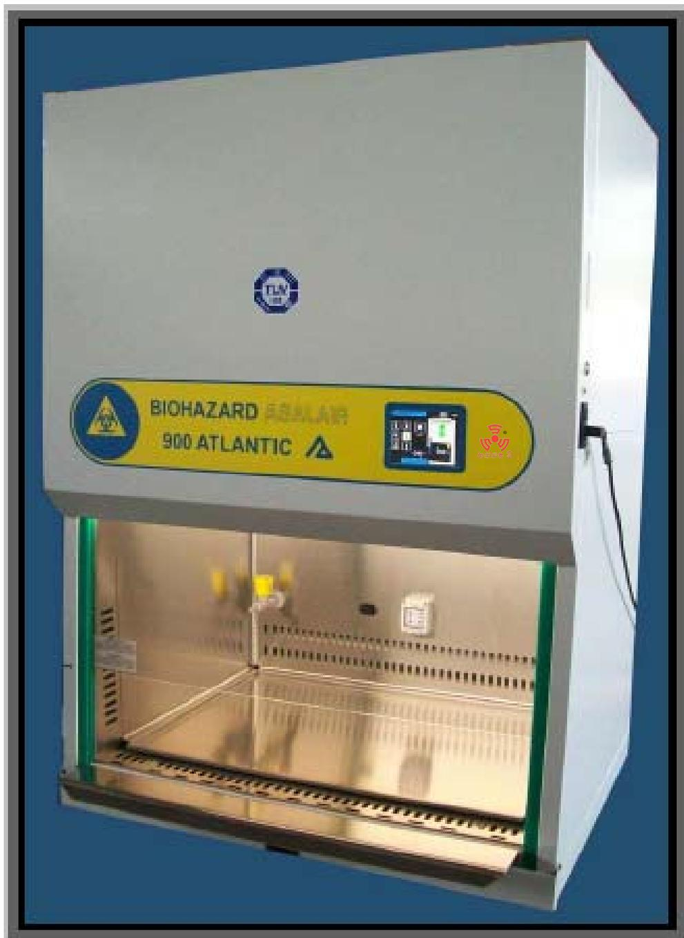
**ASALAIR BIOHAZARD ATLANTIC ES-900** est une poste de sécurité microbiologique de classe II type A2 avec flux laminaire vertical et entrée frontale à travers laquelle l'opérateur peut travailler dans la chambre de travail, et qui a été projectée et bâtie pour protéger l'opérateur, augmenter la protection du produit de la contamination externe et diminuer les risques biologiques pour l'environnement, par la filtration absolue hepa du flux d'air éjecté.
